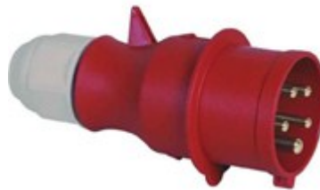
Figure 6: EN 60309-2, 3L+N+PE 6h.
